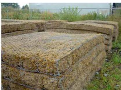
Vorgefertigte verfüllte Gabionen-Matratzen
